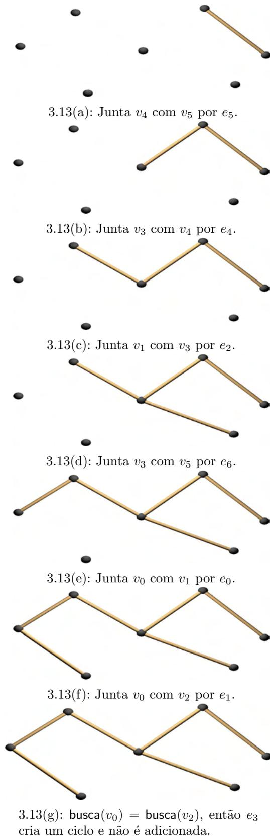
Figura 3.13: O algoritmo de árvore geradora no exemplo da figura 3.3.
